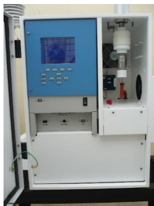
Figure 5: Partisol équipé du kit de prélèvement des pesticides
