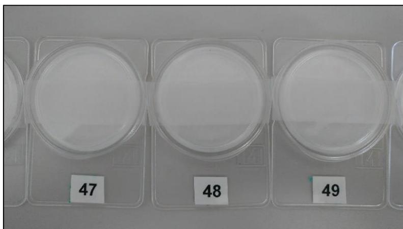
Figure 23 : Filtres en téflon conditionnés, en attente d'exposition
