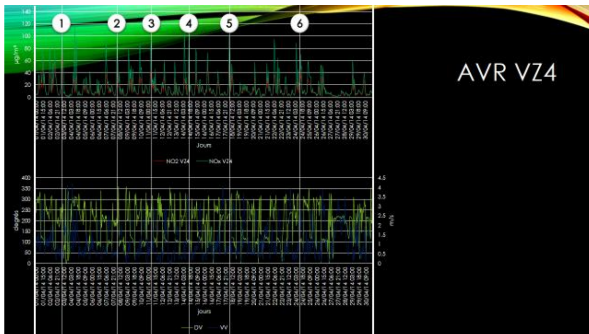
Graphique 79 : Correspondance entre les concentrations mesurées sur le site temporaire Vazzio 4 et les conditions de vents durant le mois d'avril 2014 (Source : Qualitair Corse).
