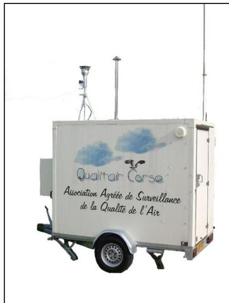
Figure 5 : Photo d'une station de type remorque vue de l'extérieur (Source : Qualitair Corse)
