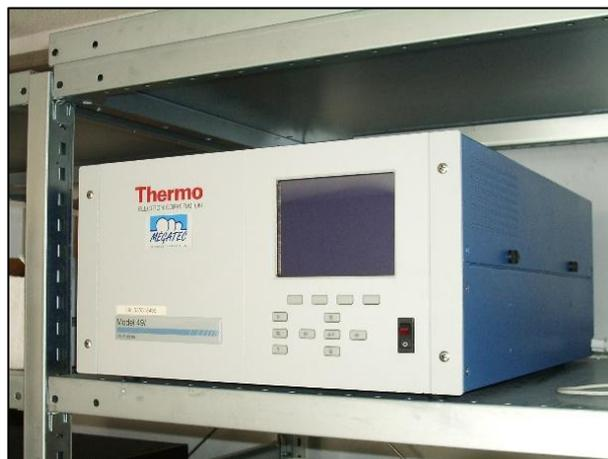
Figure 8 : Analyseur dédié aux oxydes d'azotes (Source : Qualitair Corse)
