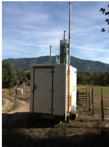
Figure 11 : Station mobile située à quelques mètres du site de surveillance industrielle de Piataniccia avec sur le toit, des mesures gravimétriques effectuées par le LCSQA
