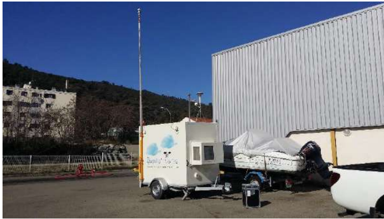
Figure 53 : Station mobile installée au niveau de la caserne des pompiers de Lucciana dans le cadre de la surveillance industrielle de la nouvelle centrale de Lucciana B
