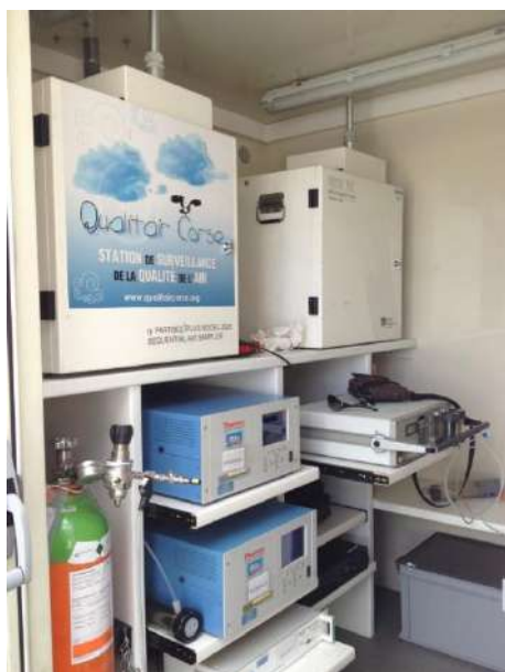
Figure 58 : Mesures des HAP et des métaux-lourds à la station de la station périurbaine d'Ajaccio - Sposata dans le cadre des évaluations préliminaires de la ZUR
