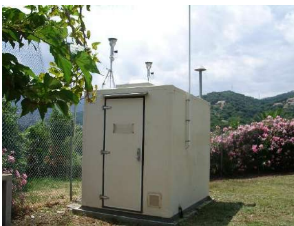
Figure 52 : Station fixe périurbaine de Bastia - Montesoro où est réalisée la mesure des PM 2,5 dans le cadre de l'IEM
