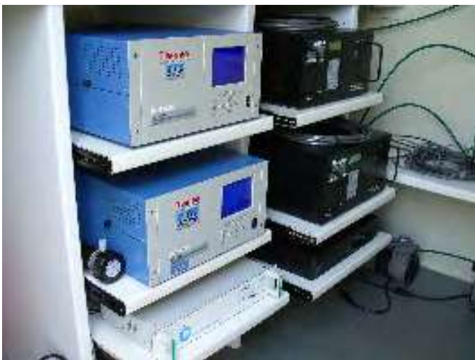
Figure 12 Analyseurs automatiques pour la mesure des polluants gazeux et particulaires réglementaires (Source : Qualitair Corse)
