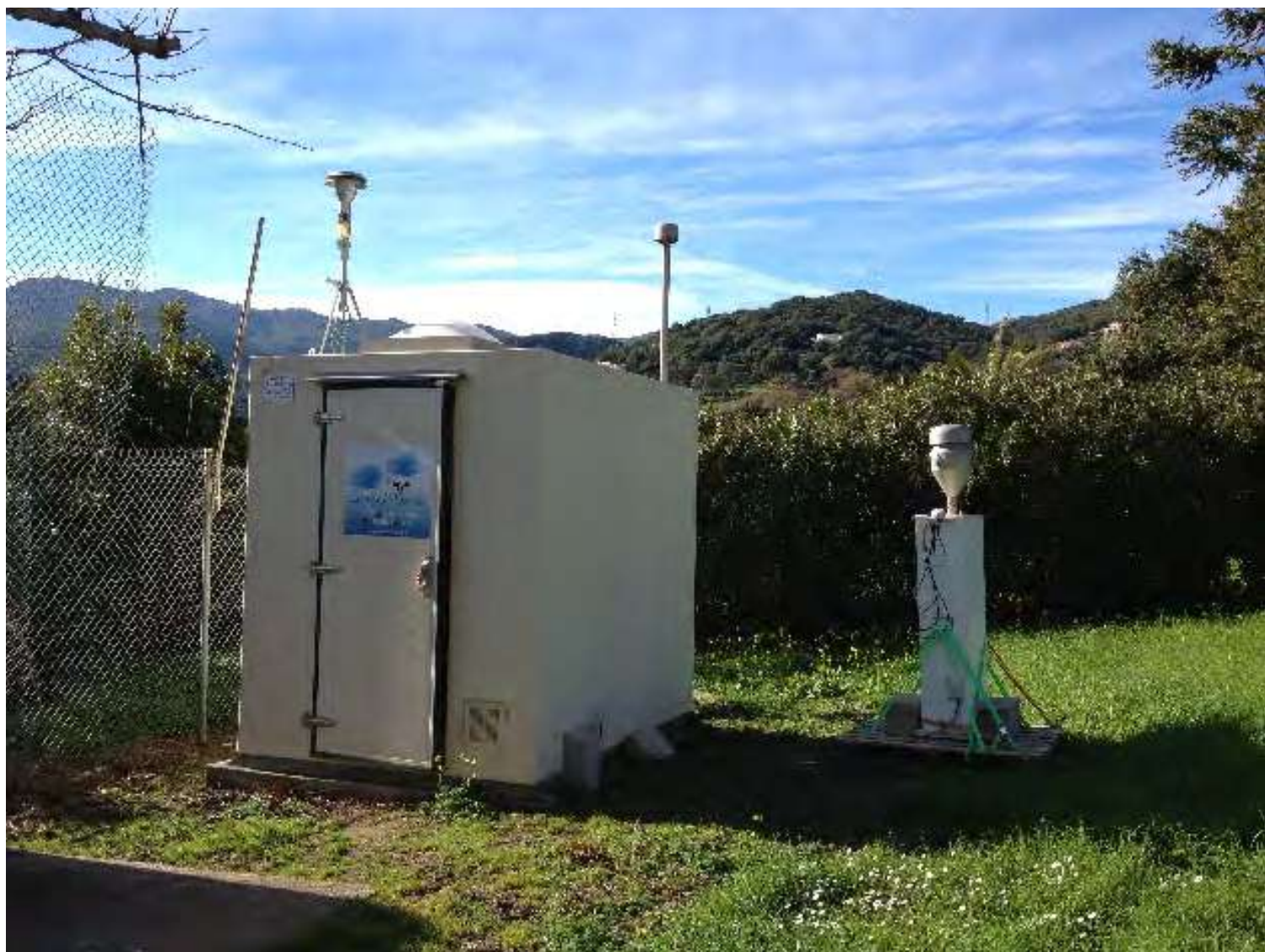
Figure 10 Station de surveillance fixe (station périurbaine de la zone urbaine de Bastia : Montesoro)
