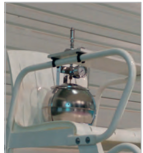
Échantillonneur pour la détermination de la présente, et l'éventuelle concentrations, des COV et composés soufrés (Source : Qualitair Corse)
