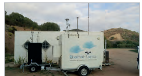
Photographie des stations mobiles de surveillance de la qualité de l'air
