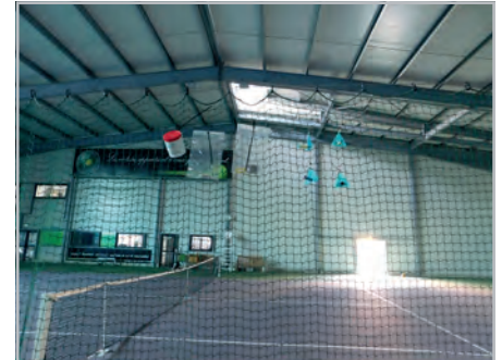
Échantillonneurs passifs formaldéhyde, benzène, \text{NO}_2 et thermomètre (Source : Qualitair Corse)
