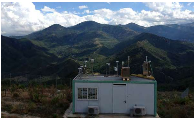
Figure n°34 - Photographie de la station de Venacu, station de référence nationale pour le suivi d'équivalence de particules fines
