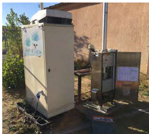
Figure n°37 - Appareils de mesure par prélèvements sur filtres dédié au suivi des métaux lourds à Corti.
