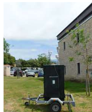
Figures n°10 et 11 - Stations mobiles de surveillance utilisées à Afà en 2018 pour effectuer le suivi de la pollution liée au brûlage de végétaux.
