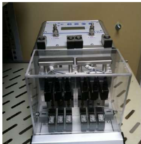
Figure n°9 - Appareil dédié à la mesure du Benzène (source : Qualitair Corse)
