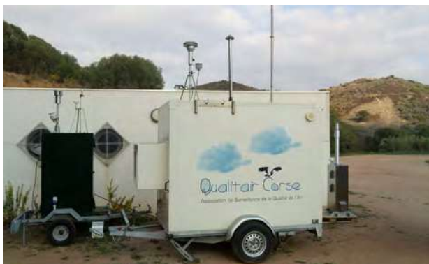
Figures n°10 et 11 - Stations mobiles de surveillance utilisées à Afà en 2018 pour effectuer le suivi de la pollution liée au brûlage de végétaux.
