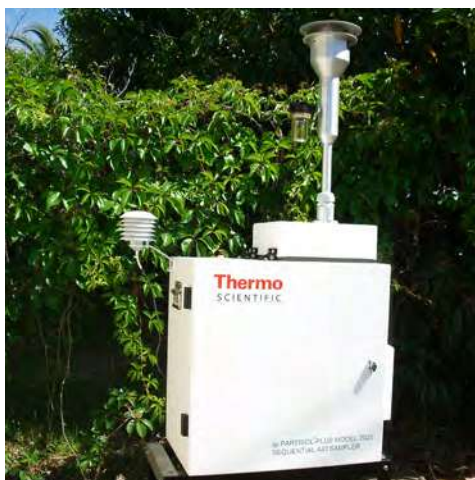
Figure n°26 - Appareil de mesures par prélèvements sur filtres dédié au suivi des métaux lourds à Montesoru.
