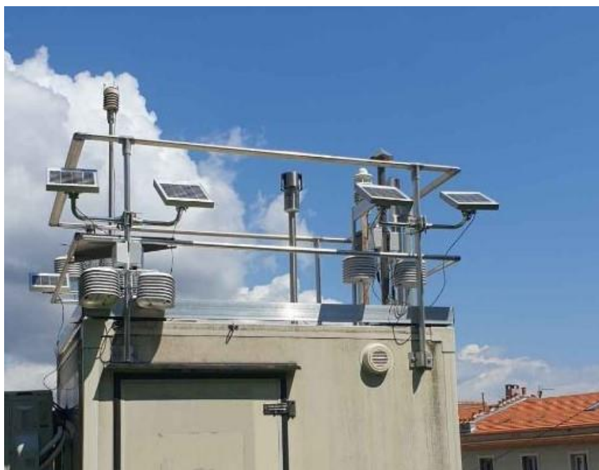
Figure 37 : Comparaison \mu Capteurs NO 2 avec station de référence Canetto
