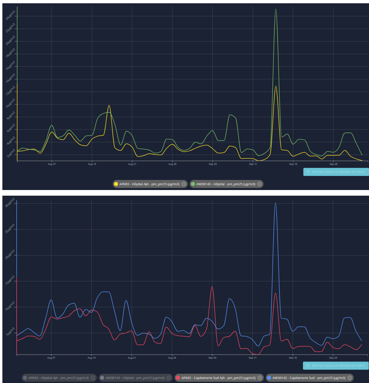
Figure 51 : Concentration en PM2.5 en extérieur (AW) et intérieur (AP) sur Ajaccio (Hôpital AJA – courbe du haut / Capitainerie Sud – courbe du bas)
