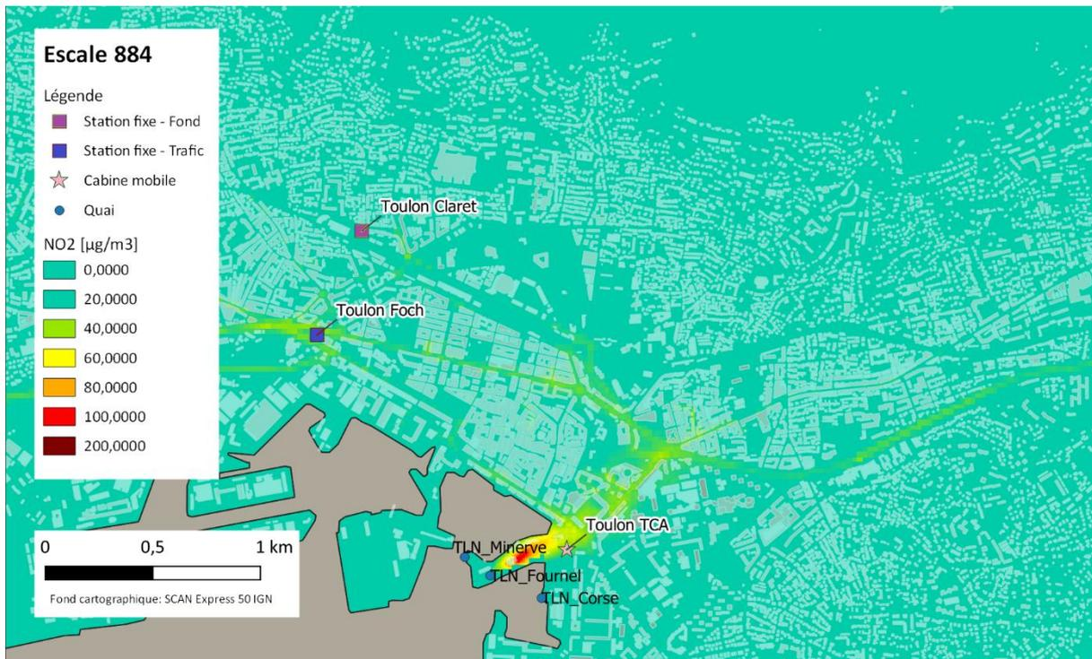
Figure 72 : Somme de la concentration en NO<sub>2</sub> simulée avec AZUR heure (contribution du trafic) et de la concentration en NO<sub>2</sub> simulée avec PMSS (contribution des navires) à Toulon, pour l'escale 884, le 22/08/21 entre 16h et 17h.
