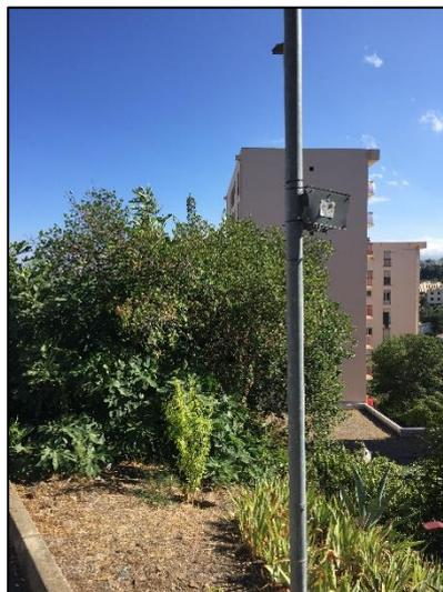
Figure 11 : Échantillonneur passif pour la mesure du benzène
