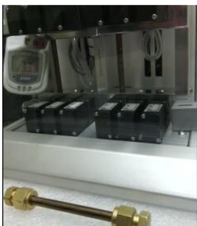
Figure 13 : Baie de prélèvement du préleveur actif pour la mesure du benzène avec les tubes remplis de Carbopack X en place
