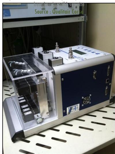
Figure 14 : Préleveur actif pour la mesure du benzène
