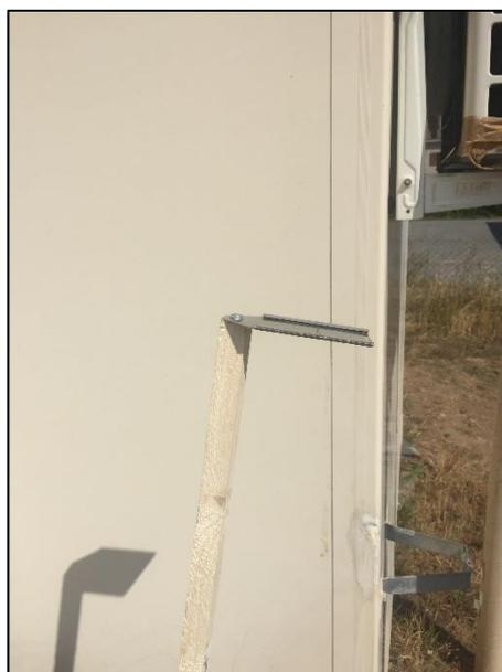
Figure 2 : Support d'une plaque de dépôt, préleveur passif de particules en suspension totales
