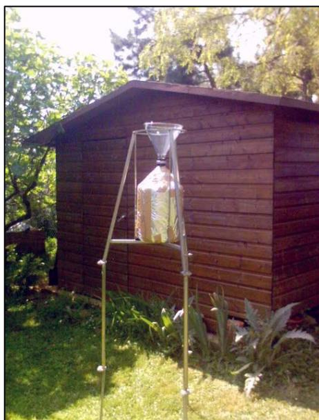
Figure 3 : Préleveur passif des particules en suspension totales de type jauge owen
