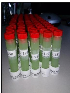
Figure 5 : Échantillonneurs passifs pour la mesure du  $\text{NO}_2$
