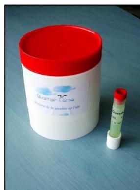
Figure 4 : Échantillonneur passif pour la mesure du  $\text{NO}_2$  et sa boîte de protection
