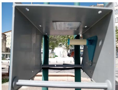
Figure 1 : équipement de prélèvement du benzène
