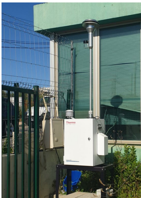
Figure 2 : Partisol équipé du kit de prélèvement des pesticides, site de La Marana Source : Qualitair Corse
