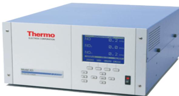
Figure 4 : Analyseur d'oxydes d'azotes 42i
