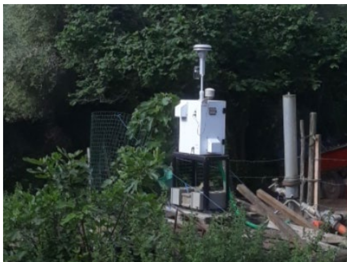
Figure 2 : Partisol équipé du kit de prélèvement des pesticides, site de La Marana Source : Qualitair Corse
