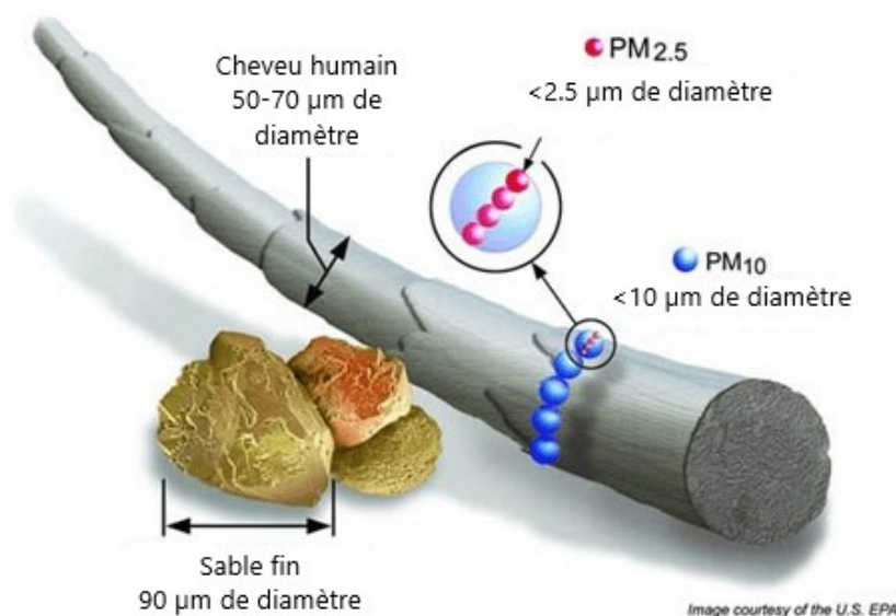
Figure 1 : Schéma des différentes tailles de particules
