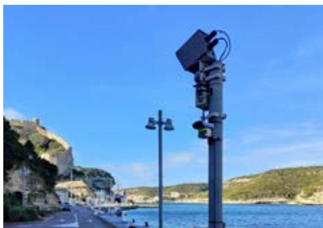
Capteur PM installé au sein du port de Bunifaziu
